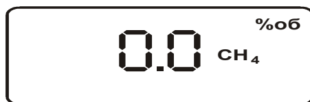
Рисунок 5 Символы на ЖКИ, соответствующие режиму измерения метана
