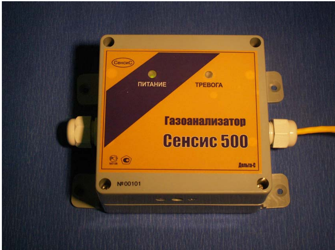
Рис 2. Внешний вид датчика системы контроля газов (стационарного газоанализатора «Сенсис 500»)
