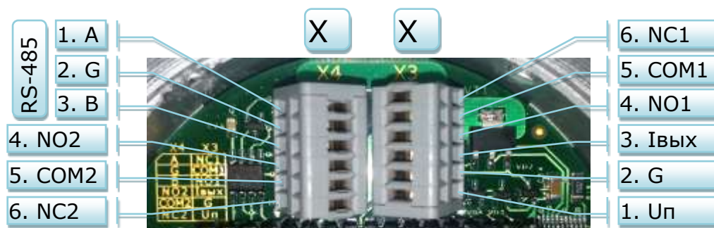
Рис. 5 Расположение и назначение клеммных контактов
