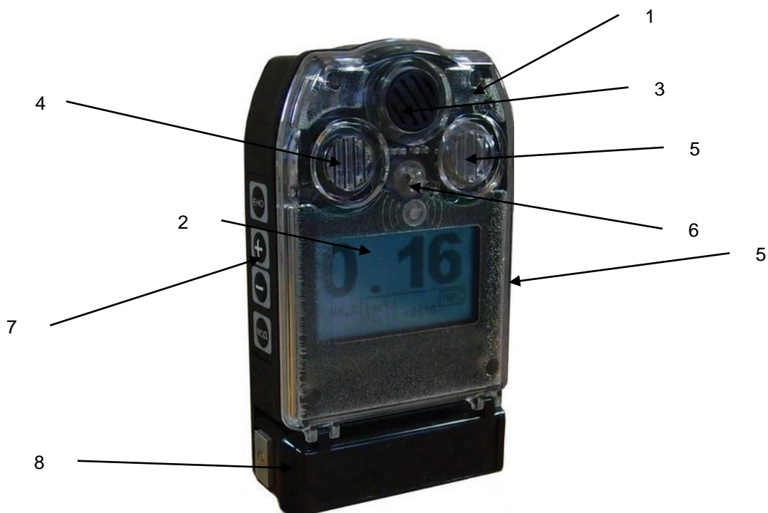
Рис. 1. Общий вид газоанализатора всех модификаций за исключением АТЕСТ-1.Д.3. 1 – аварийные светодиодные индикаторы, 2 – ЖКИ, 3 – датчик метана, 4 – датчик кислорода, 5 – датчик СО или датчик СО 2 , 6 – звуковой излучатель, 7 – четырехкнопочная клавиатура, 8 – батарейный отсек.
