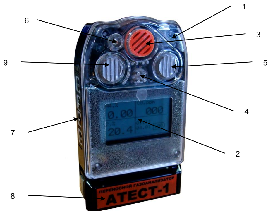
Рис. 2. Общий вид газоанализатора АТЕСТ-1.Д.3. 1 – аварийные светодиодные индикаторы, 2 – ЖКИ, 3 – датчик метана, 4 – датчик кислорода, 5 – датчик СО 2 , 6 – звуковой излучатель, 7 – четырехкнопочная клавиатура, 8 – батарейный отсек, 9 – датчик СО.
