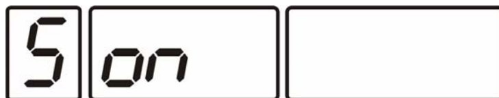
Рисунок 16 Вид индикатора, когда звуковая сигнализация включена
