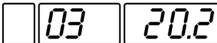
Рисунок 12 Канал 3 – измерение концентрации кислорода
