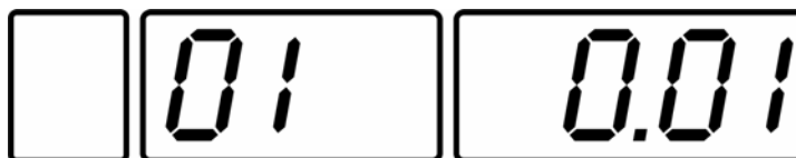
Рисунок 10 Канал 1 – измерение концентрации метана
