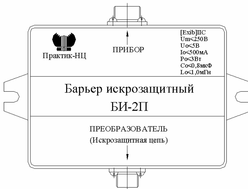
Рисунок 6 Внешний вид искрозащитного барьера БИ-2П
