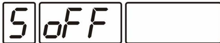
Рисунок 17 Вид индикатора, когда звуковая сигнализация отключена
