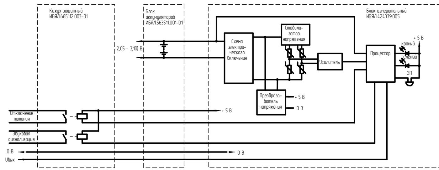
Рисунок 11 – Сигнализаторы СГШР. Схемы электрические функциональные
