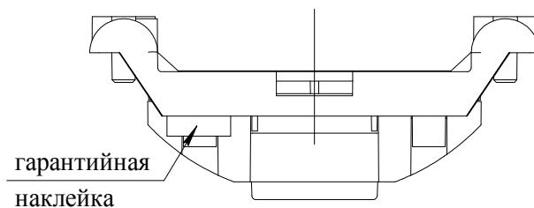
Рисунок 2 - Схема пломбировки сигнализатора от несанкционированного доступа
