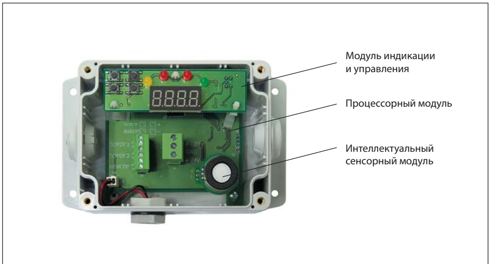
Рис.2. Основные узлы газоанализатора "Сенсон-СВ-5024"
