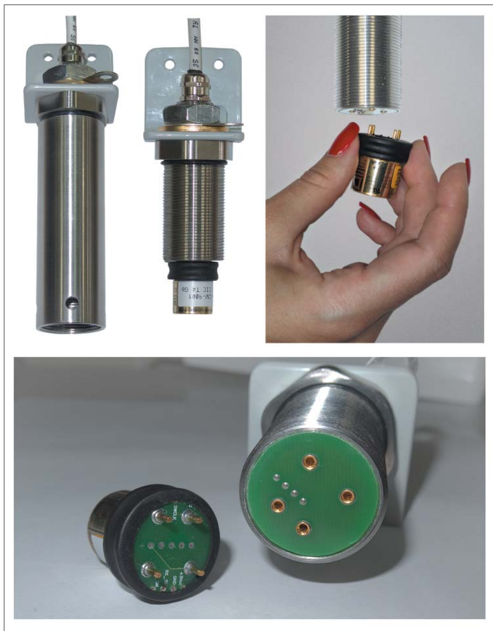
Рис.2. Подключение интеллектуального сенсорного модуля
