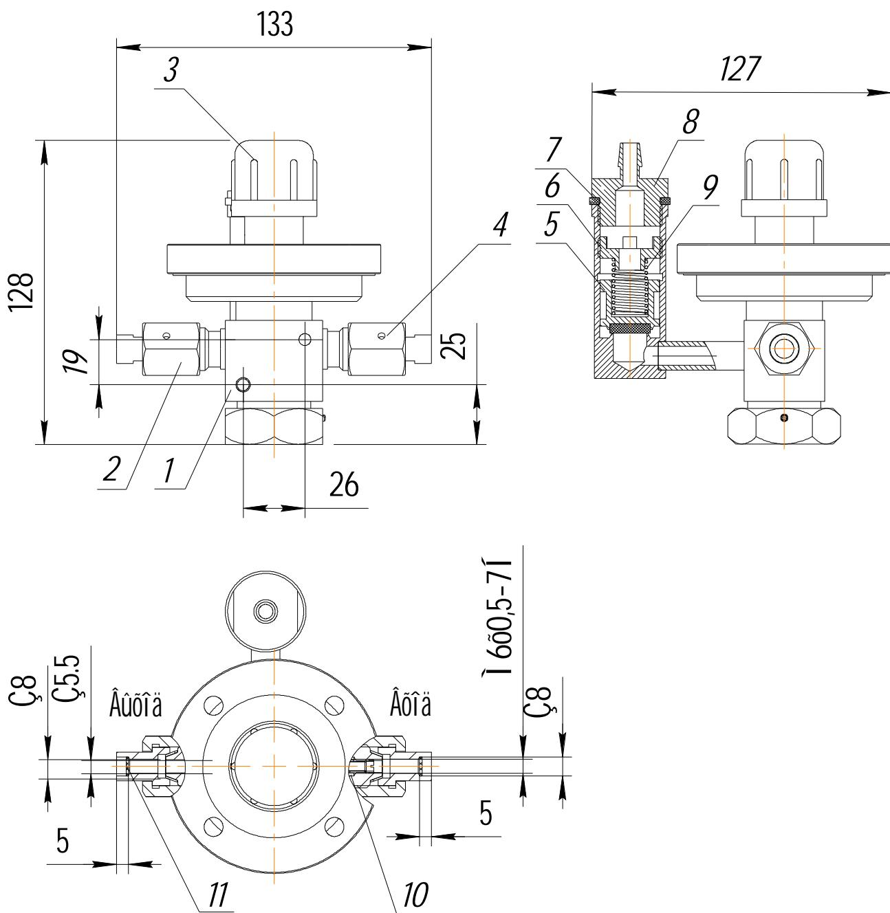
1 – корпус; 2 – выходной ниппель; 3 – колпачок; 4 – входной ниппель; 5 – клапан; 6 – гайка;
