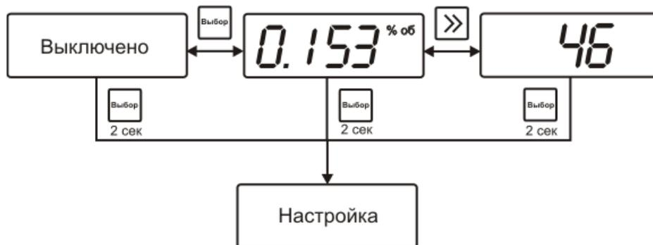
Рисунок 5.1 Схема режима **РАБОТА**
