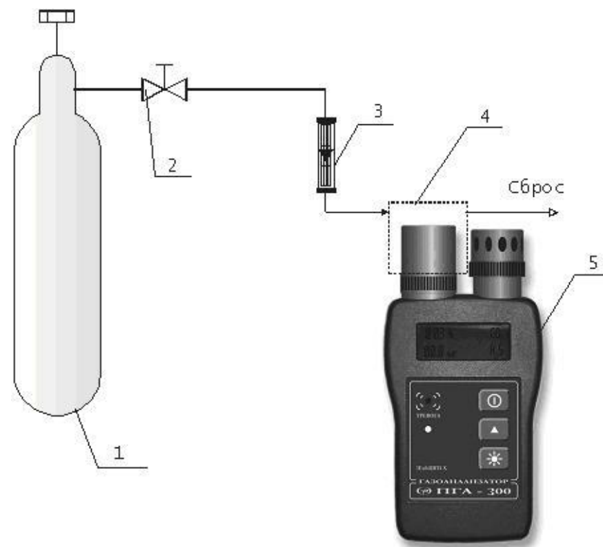
Схема подачи ГСО-ПГС на газоанализаторы ПГА-300
