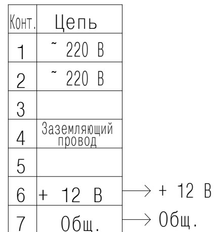
Рисунок 2. Схема подключения газоанализаторов при питании напряжением ( 12^{+3}_{-1} ) В от аккумулятора или бортовой сети
