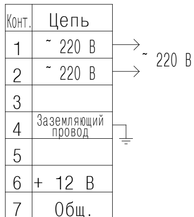
Рисунок 1 - Схема подключения газоанализаторов к электрической сети питания переменным однофазным током с напряжением ( 220^{+22}_{-33} ) В и частотой ( 50 \pm 1 ) Гц
