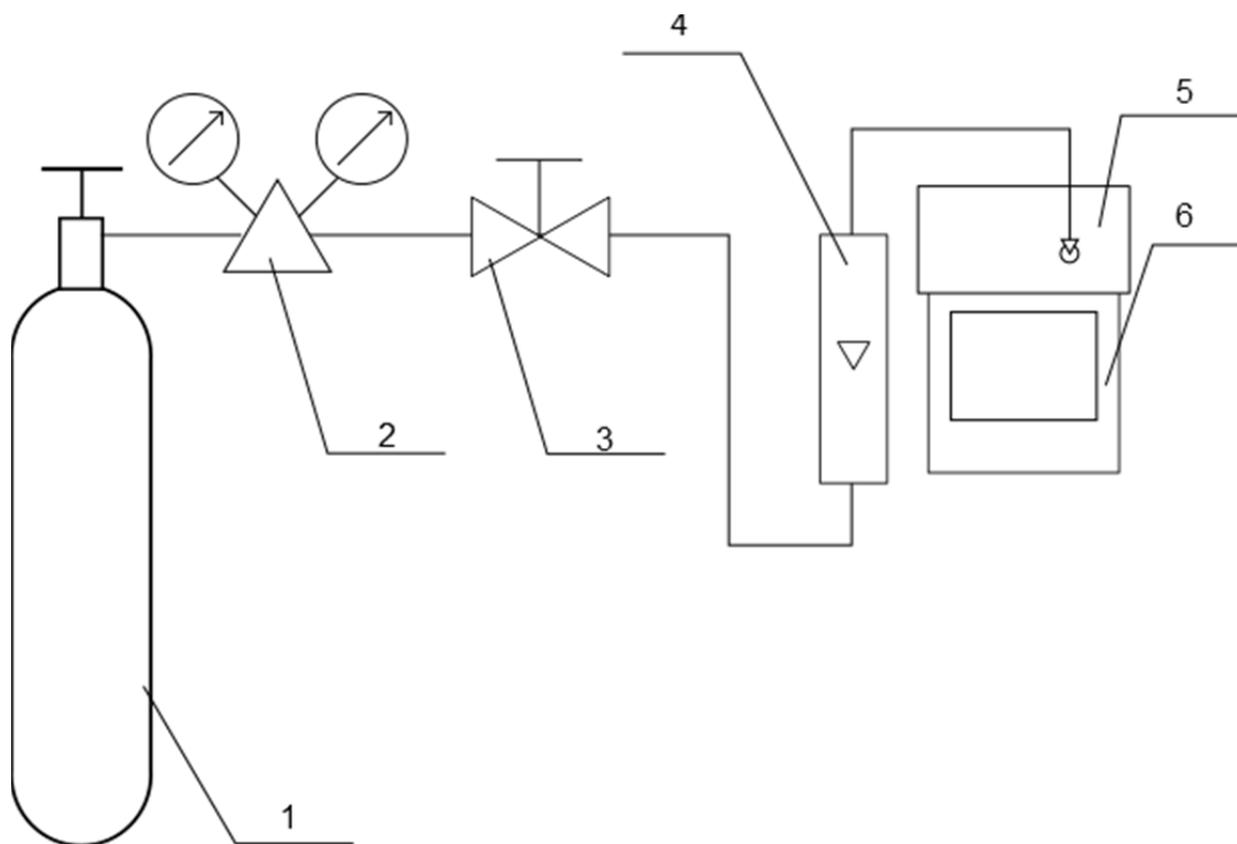
1 – баллон с ГС; 2 – редуктор баллонный; 3 – вентиль точной регулировки; 4 – индикатор расхода (ротаметр); 5 – насадка для подачи ГС; 6 – газоанализатор.
