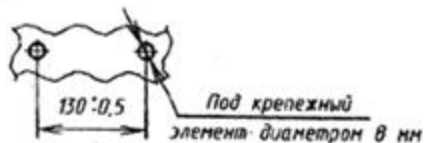
Разметка для крепления преобразователя первичного поз 2
