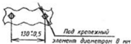
Разметка для крепления преобразователя первичного поз. 2
