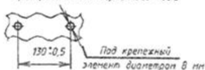
Разметка для крепления преобразователя первичного поз.2
